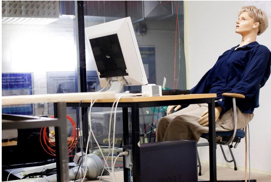
Figur 1-8 Termisk mannequin i et klima kammer tilhørende til Center for Indeklima og Energi, DTU Byg. Kilde: Danmarks Tekniske Universitet
