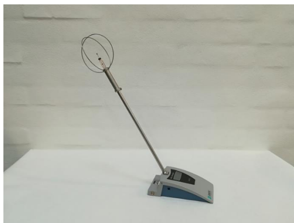
Figur 1-20: Venstre: Føler til direkte målinger af operativ temperatur. Højre: Føler til målinger af lufthastighed. Kilde: forfatteren
