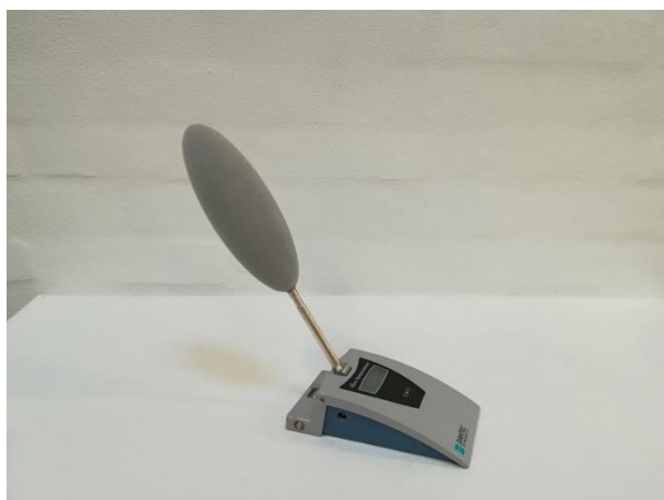
Figur 1-20: Venstre: Føler til direkte målinger af operativ temperatur. Højre: Føler til målinger af lufthastighed. Kilde: forfatteren
