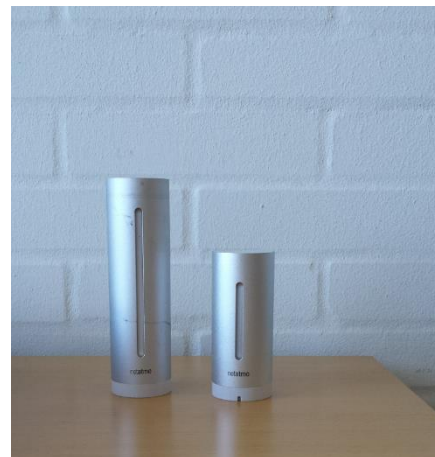
Figur 1-22 Eksempel på kommercielt tilgængelige indeklimaloggere: IC-meter (til venstre) og Netatmo (til højre). Kilde: forfatteren
