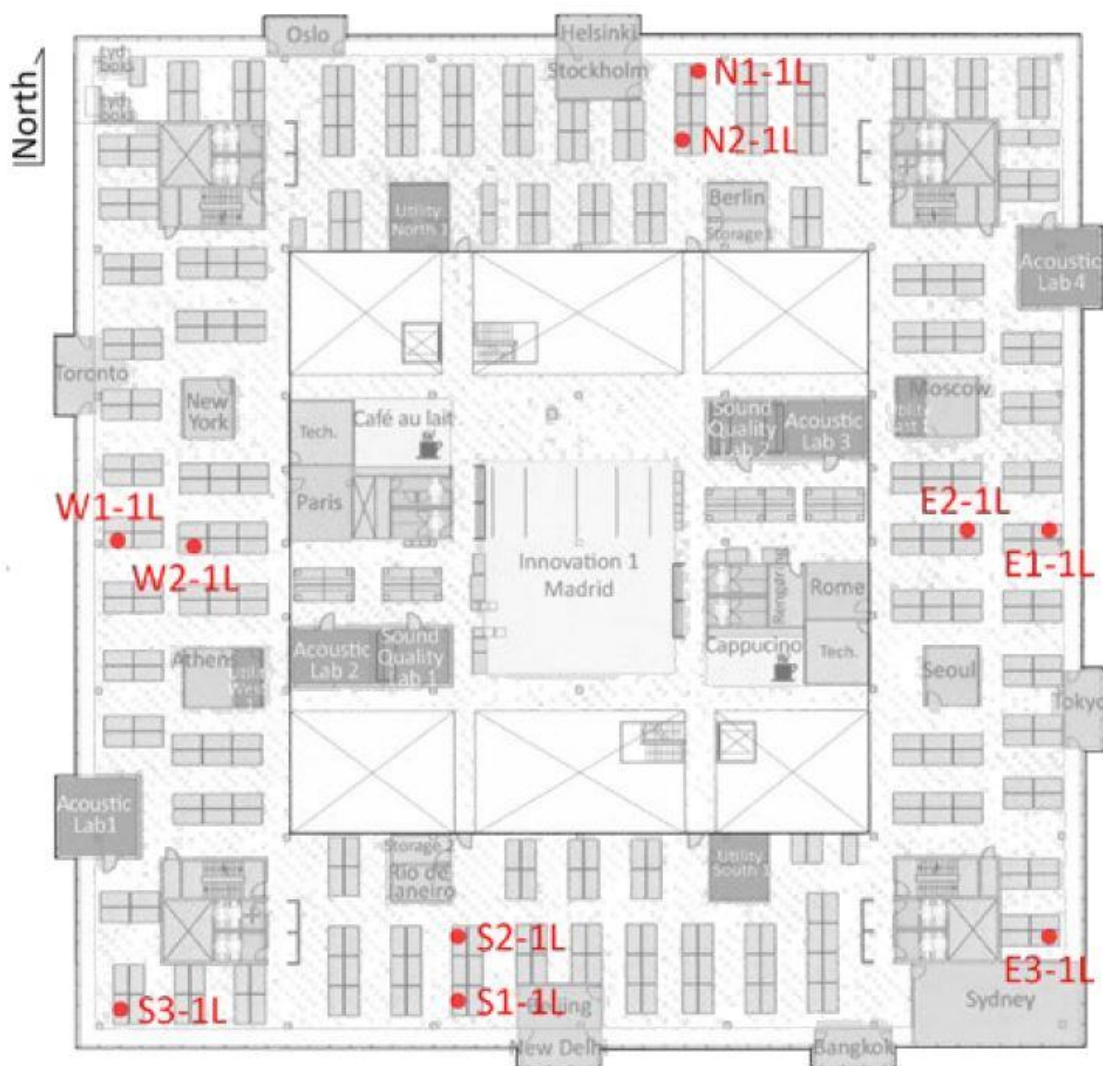
Figur 1-23 Plantegning af en kontorbygning med afmærkede målepunkter; bygningen er delt i zoner – nord (N), syd (S), øst (E), vest (W). Målepunkter i midten af zonerne er repræsentative, målepunkter tæt på facaden eller i hjørner er kritiske steder. Kilde: Døi (2016)
